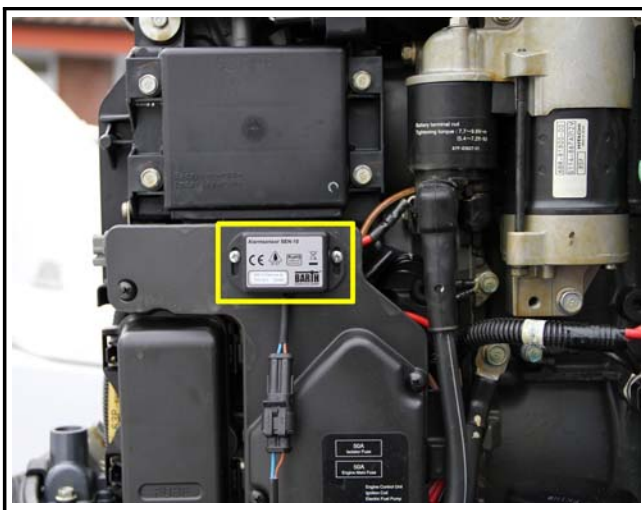
Abbildung 3: Montage des Alarmsensors SEN-10
